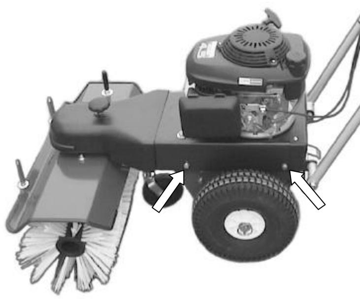
Lösen Sie rechts und links jeweils die beiden Schrauben der Motor-Konsole (Pfeile, SW13). Nun kann das Bürstendeck vor und zurück geschoben werden. In der neuen Pos. die Schrauben wieder sorgfältig befestigen.
